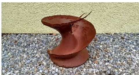
L'état d'usure après 15 ans d'utilisation !
