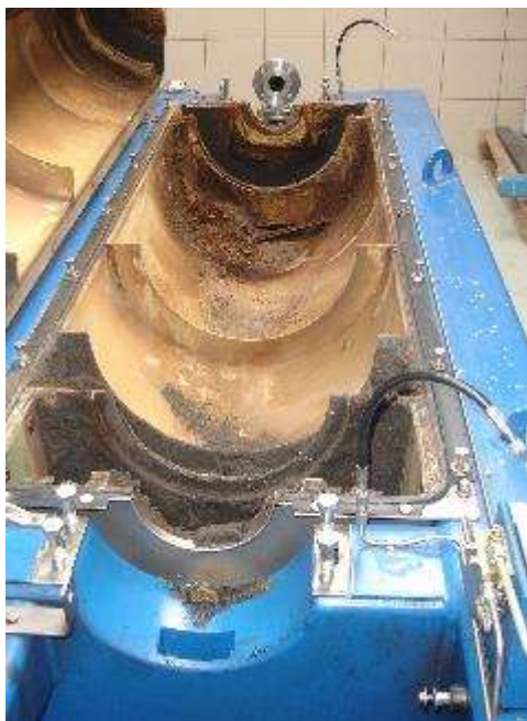
Révision centrifugeuse : après 9'200 heures
